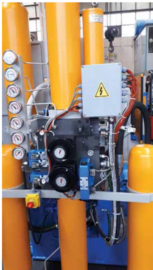
Układ do regulacji docisku maszyny o sile 300 ton
