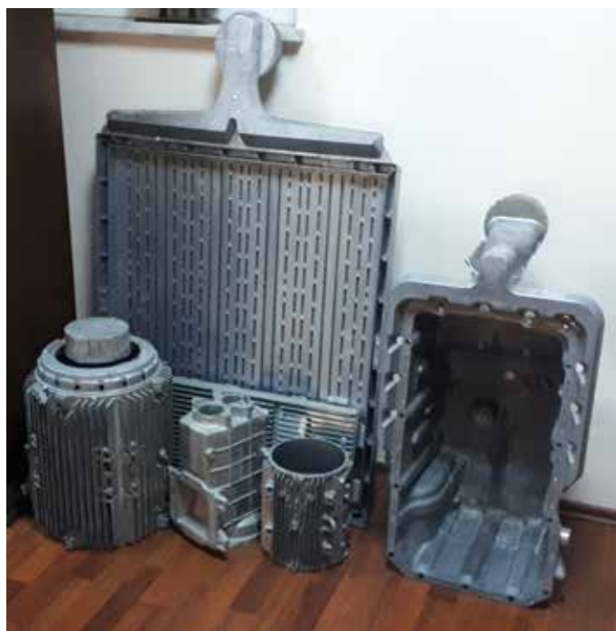
Przykładowe odlewy ze stopów aluminium otrzymane na maszynach
