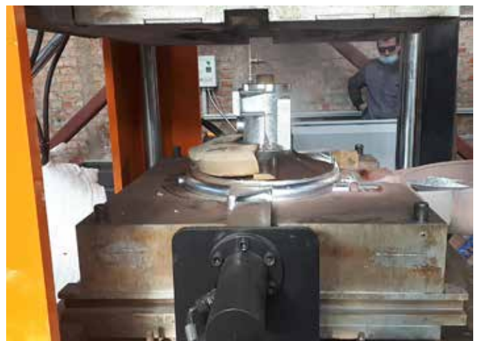
Powstały odlew korpusu pompy przed wyjęciem z matrycy
