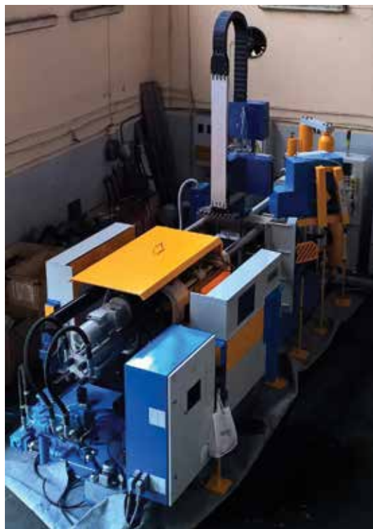
Wtryskarka z komorą prasowania na zimno o sile zamykania 200 ton z automatycznym napełnianiem i smarowaniem
