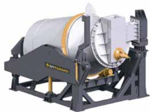
Piec obrotowy z nachyloną osią obrotu do topienia złomu
