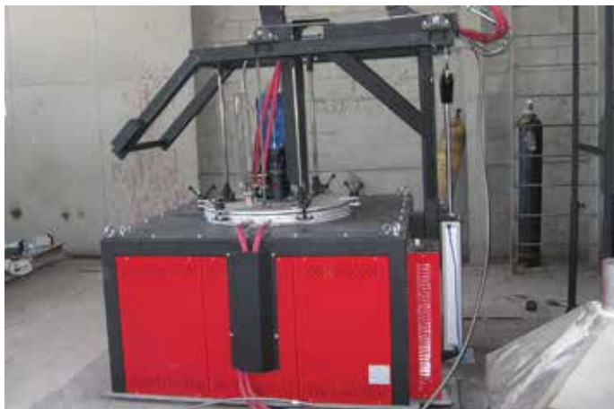
Шахтная печь с газоплотной ретортой и циркуляцией атмосферы для термообработки металлов в защитной атмосфере и проведения химико-термической обработки
