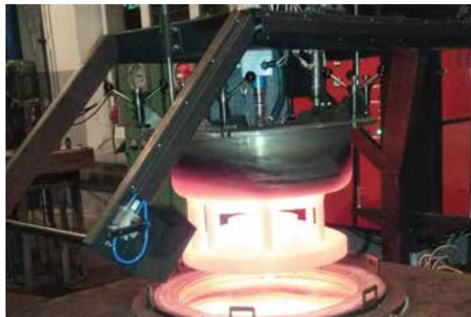
Шахтная печь с газоплотной ретортой и циркуляцией атмосферы для термообработки металлов в защитной атмосфере и проведения химико-термической обработки
