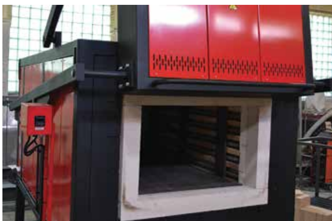
Piece komorowe do obróbki cieplnej metali
