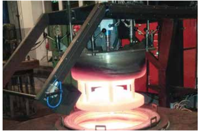
Piece szybowe z gazoszczelną retortą i cyrkulacją atmosferyczną do obróbki cieplnej metali w atmosferze ochronnej oraz do obróbki chemicznej i termicznej
