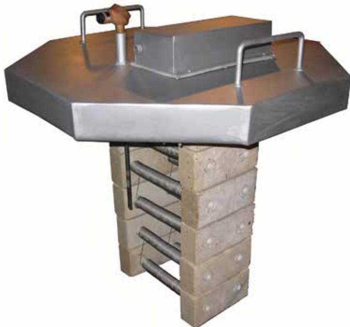
Uchwyt podgrzewacza odlewniczego i suszarki
